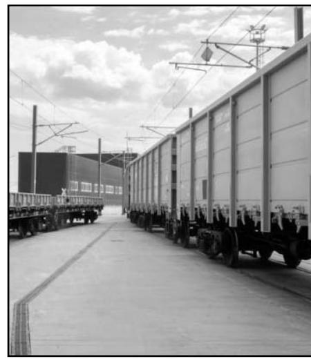
Platforma vaqonlarda konteynerlər yanaşı, taxta-şalban, boru, rels, ağır və iriölçülü digər yükleri daşımaq mümkündür. Sadələşdirilmiş dizaynı sayəsində yan və yuxarı hissələrdən yükləmə və boşaltma işləri asan həyata keçirilir, nəticədə vaqonda aparılan yükləmə və ya boşaltma əməliyyatının müddəti azalır.
